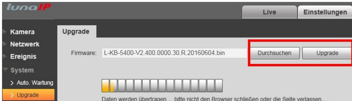
Das Upgrade dauert ca. fünf Minuten. Während des Vorgangs wird eine Fortschrittsanzeige eingeblendet. Ist die Installation der Datei abgeschlossen startet das Gerät eigenständig neu.
