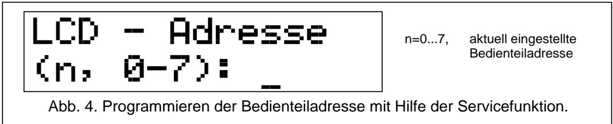
Abb. 4. Programmieren der Bedienteiladresse mit Hilfe der Servicefunktion.
